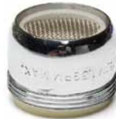
Los aereadores para llaves son discos con mallas, generalmente hechos de metal que se enroscan al cabezal de la llave para reducir el flujo de agua. Se consiguen aereadores para las llaves de la cocina de muchas formas y modelos. Estos aereadores requieren que se estén limpiando frecuentemente para que no se obstruya el flujo normal del agua.
